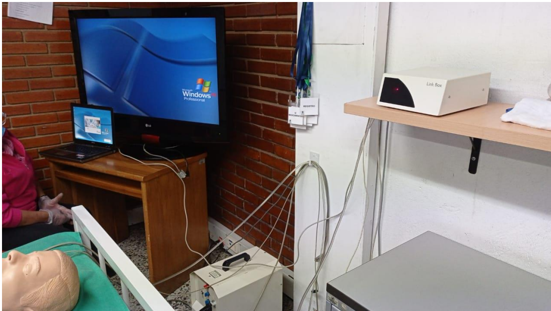
IMAGEN No 32: Link Box PLUS (Laerdal), dispositivo clave que conecta el simulador con el sistema de control SimPad PLUS, permitiendo la comunicación, energía y activación de los maniqués durante los casos clínicos simulados.
