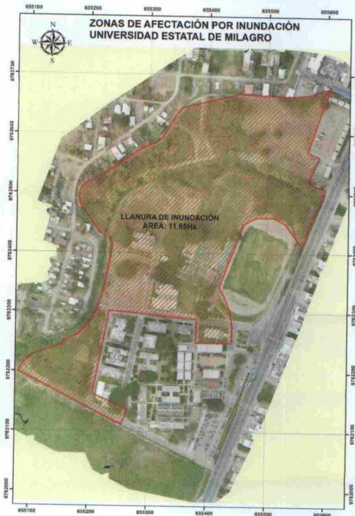
Tomando en consideración que las zonas de expansión para los bloques futuros están ubicadas precisamente dentro de la llanura de inundación del Estero Belín, se deberán realizar rellenos a los terrenos, previo a la construcción de los sistemas de abastecimiento de agua potable, alcantarillado sanitario, drenaje pluvial y edificaciones. La cota de inundación se determinó en 9.50m, se deberá rellenar hasta la cota 9.70m para tener un margen de seguridad.
